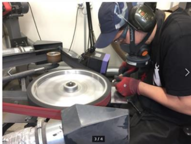
An der Schleifmaschine wird das Messer in seine Form geschliffen. CHRISTIAN LECHTNER
