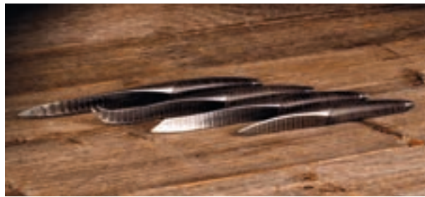
Couteaux en acier damassé en torsion avec 1000 couches.
