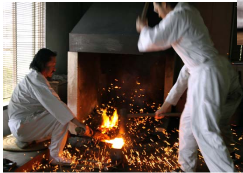
Fujiwara Kanefusa beim Schmieden von Damaststahl
